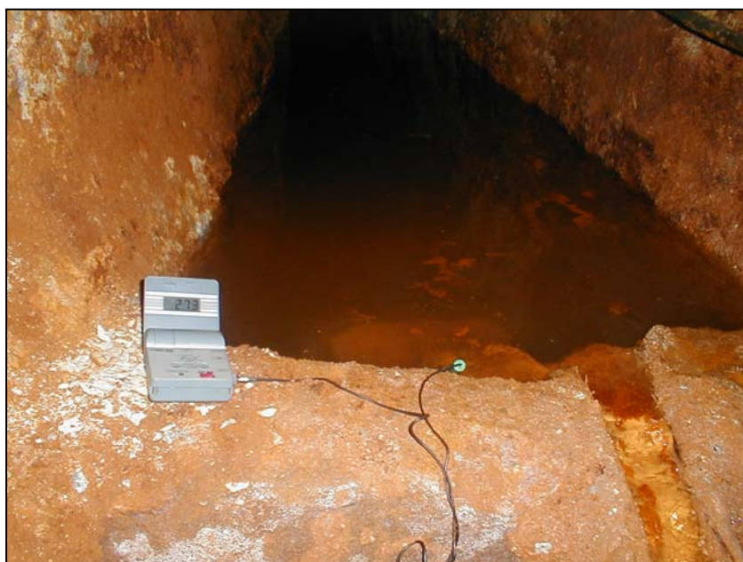
Fig. 1: misura del pH alla sorgente acida, arsenicale-ferruginosa di Fovi di Baselga (TN) (G. Brozzo, Agosto 2000)
